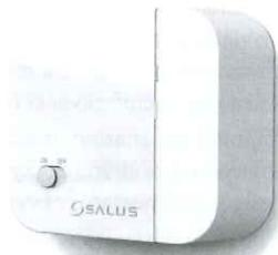
Na předním krytu přijímače vidíte spínač zap./vyp. a dvě LED diody. Spínač umožňuje v případě potřeby vypnout přijímač, aby nevysílal signál k vytápění. Vrchní LED (červená) se rozsvítí, pokud je spínač v poloze „zap.“ a jednotka je napájena. Spodní LED (zelená) se rozsvítí, pokud jednotka přijímače přijímá vysílaný signál k vytápění z vysílače (termostatu).
