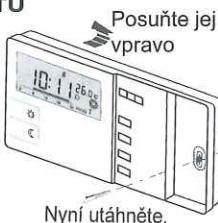
Pokud váš termostat nepracuje správně, zkонтrolujte prosím polaritu baterií a pomocí kuličkového pera stiskněte tlačítko reset.
